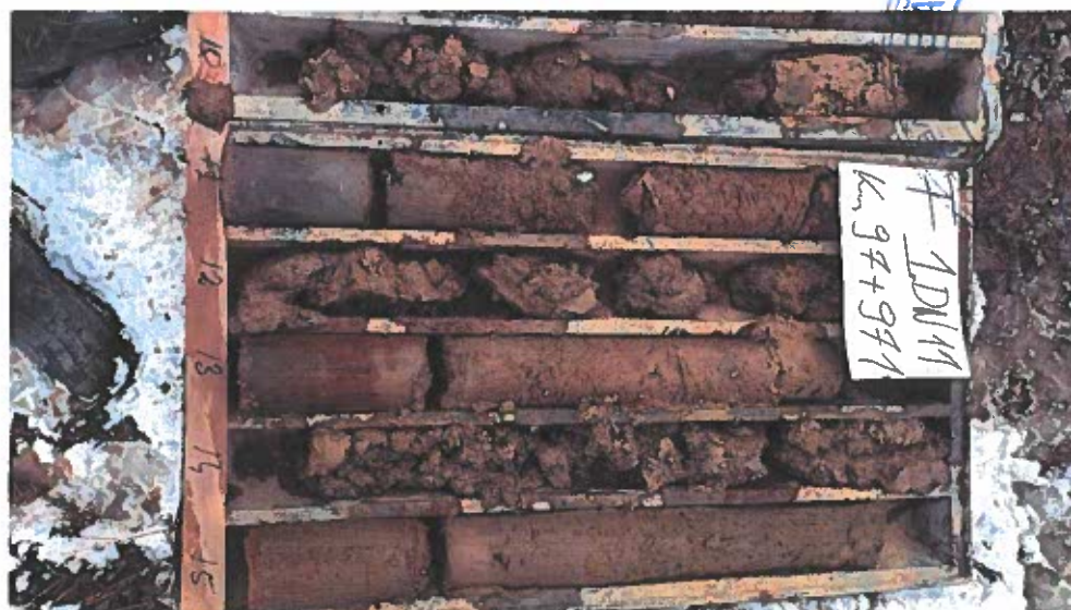
Figura 10.c: Stratificația întâlnită în forajul F1
