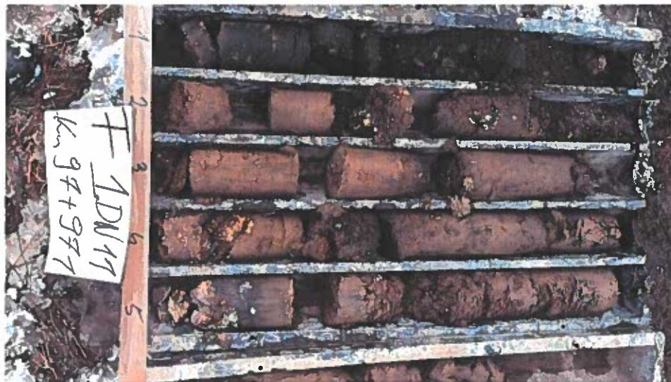
Figura 10.a: Stratificația întâlnită în forajul F1
