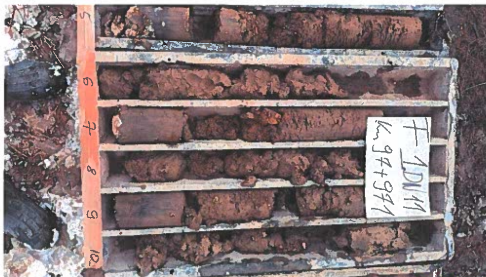
Figura 10.b: Stratificația întâlnită în forajul F1
