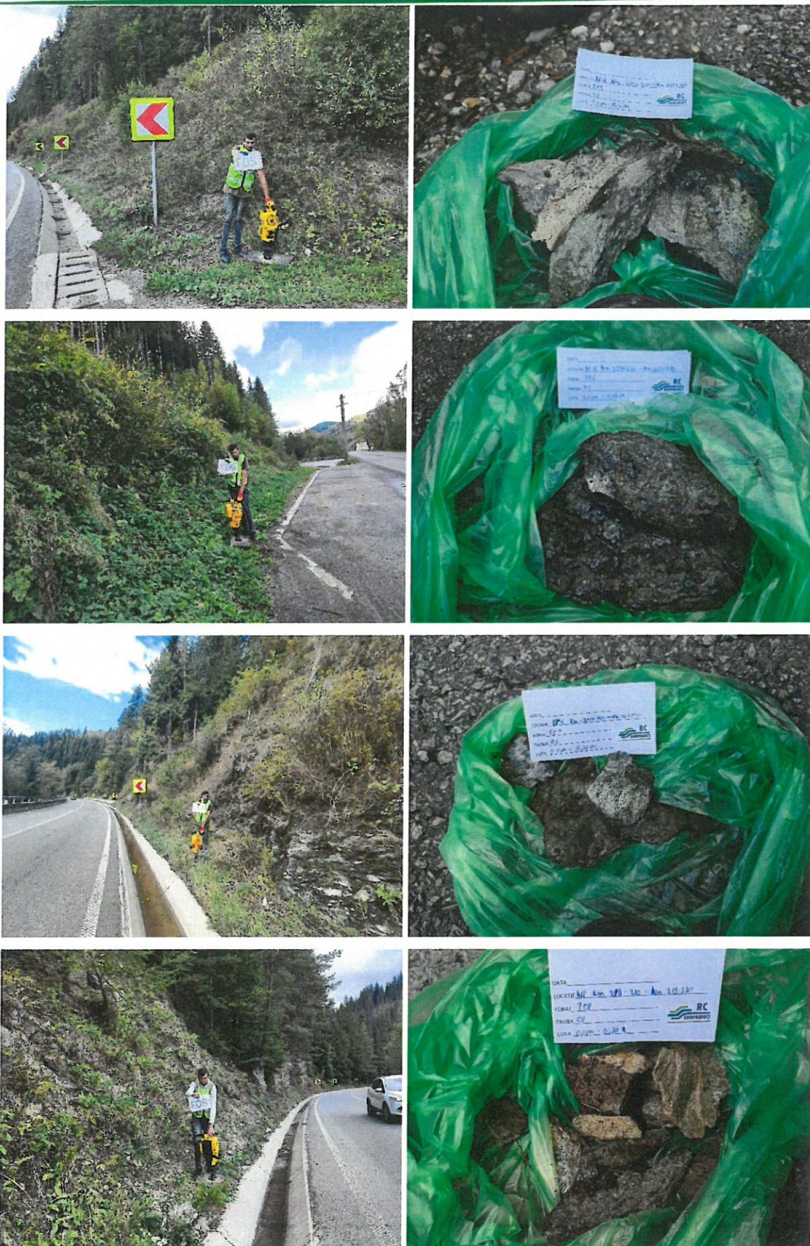
Fig. 17. Investigații geotehnice și prelevare probe de pământ
