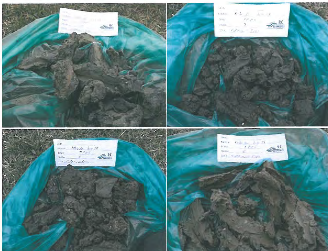
Fig. 19. Investigații geotehnice și prelevare probe de pământ
