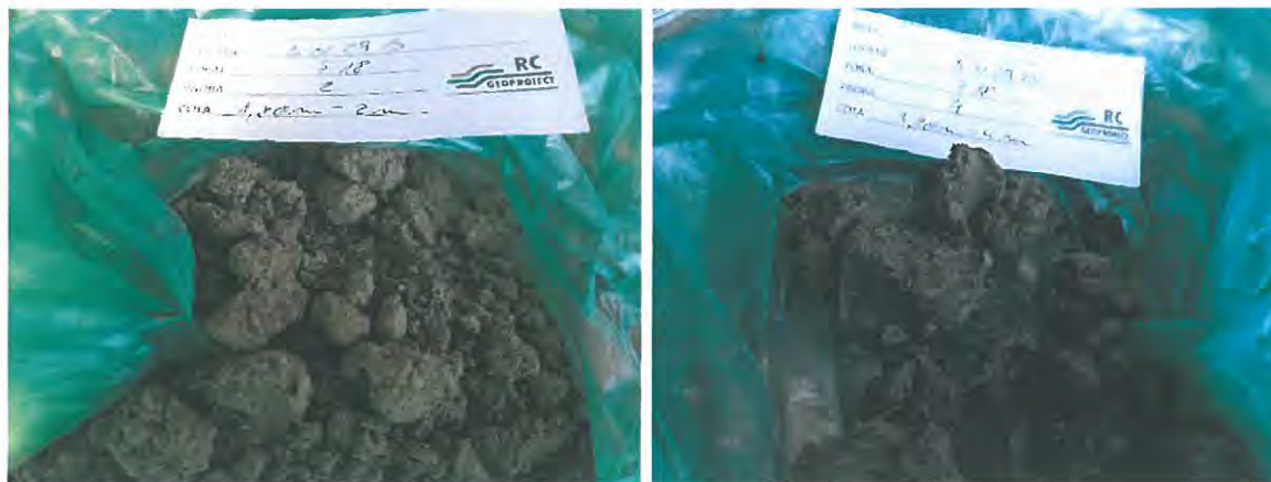
Fig. 19. Investigații geotehnice și prelevare probe de pământ
