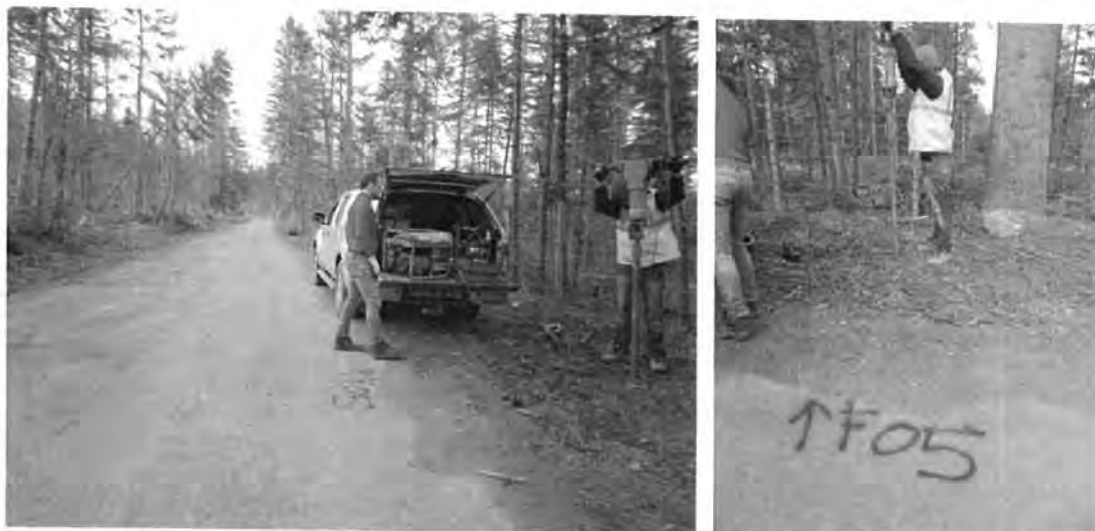
Figura 4.3.5. Realizare foraj geotehnic F05 și prelevarea eșantioanelor de pământ
