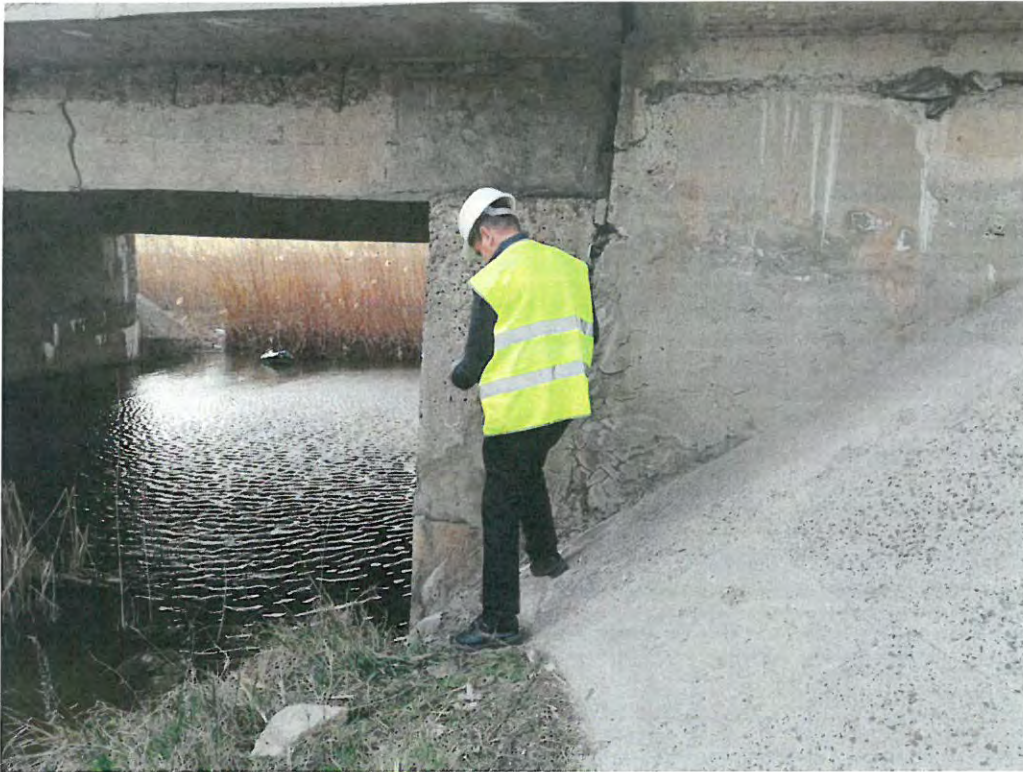
Încercare culee stanga cu sclerometrul
